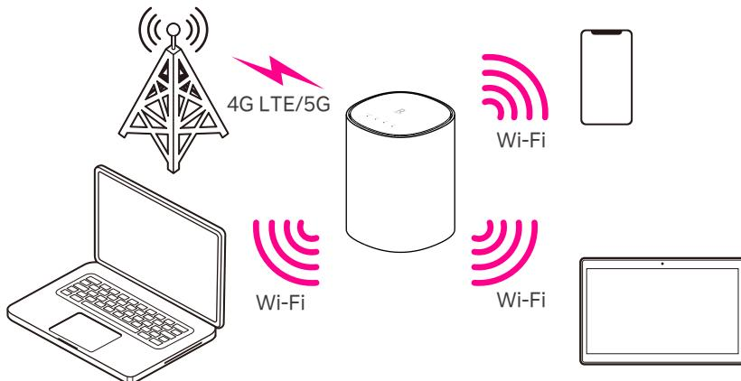
また、LANケーブルを使って有線で接続することができます。本製品は2台まで有線で接続できます。LANケーブルで接続中でも、Wi-Fi接続を同時に使用することができます。
